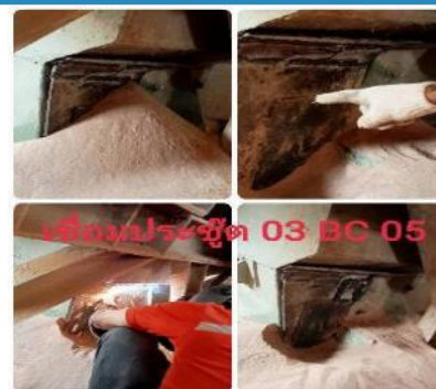
ตรวจสอบหน้างาน เชื่อมปะทุที่ 03BC05
